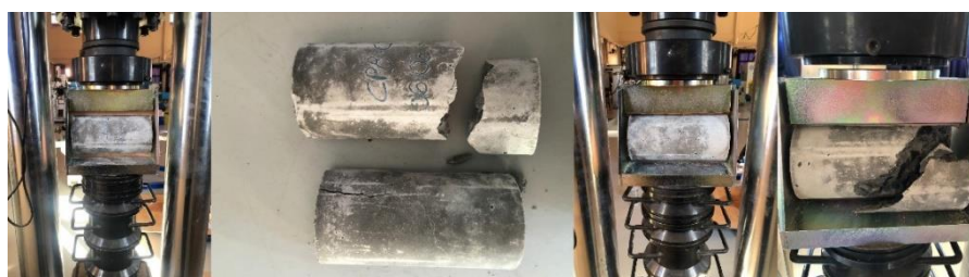
Figura 3. Ensaio de tração por compressão diametral (Fontes: os próprios autores)
