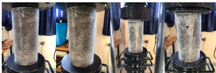
Figura 2. Ensaio de compressão axial (Fontes: os próprios autores)
