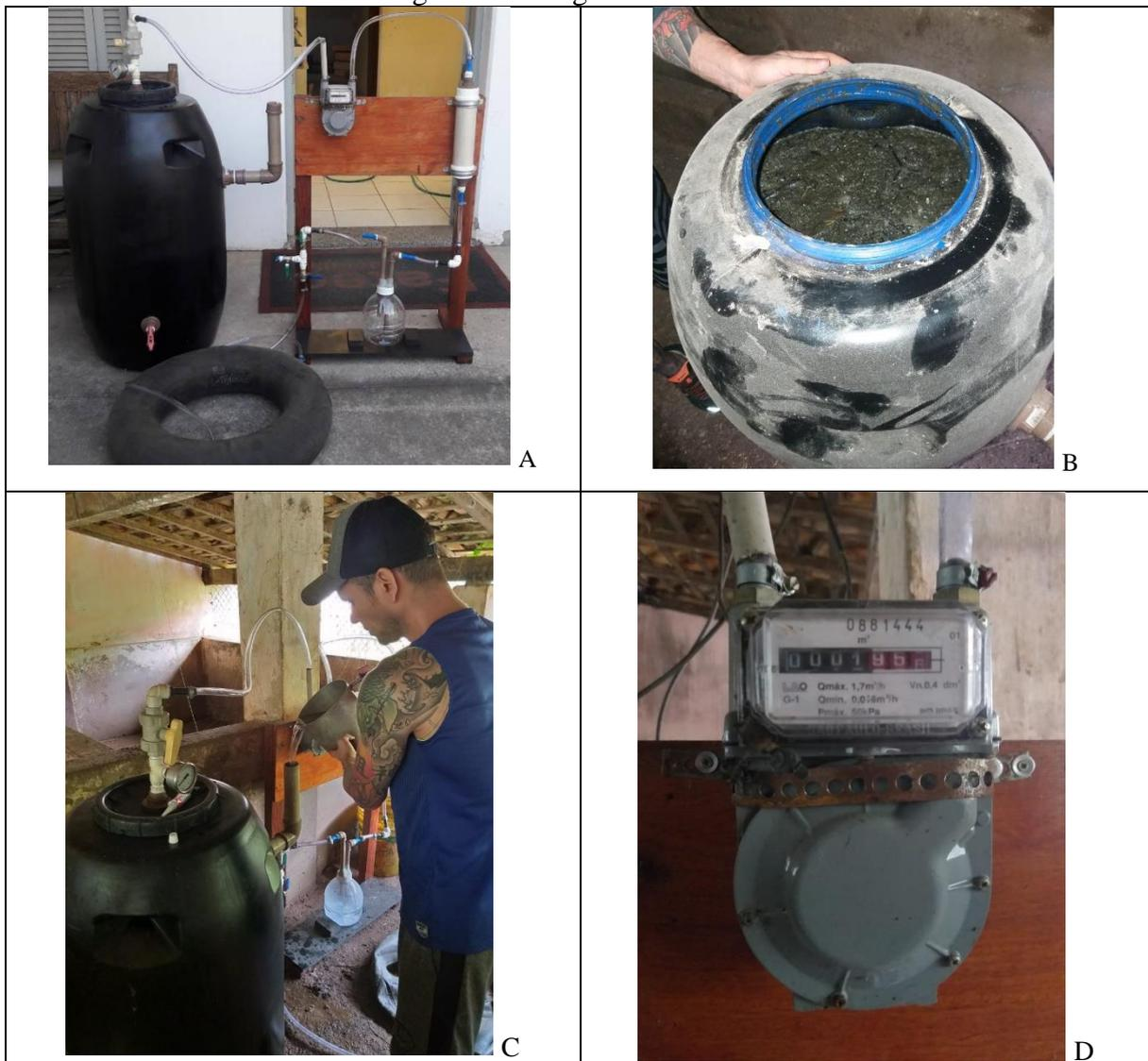
O recipiente utilizado para a câmara foi uma bombona plástica de 250L, onde ocorre a decomposição da matéria orgânica, através da fermentação anaeróbica. Inicialmente foi realizado um furo de 20 mm de diâmetro na parte inferior da bombona, para extração do biofertilizante. Neste furo foram acoplados: um adaptador com anel e por fim uma torneira registro. Na parte superior, na tampa
