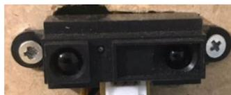
Figura 2 - Sensor Sharp GP2Y0A41SK0F. Fonte: O Autor
