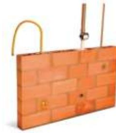
FIGURA 1. Esquema de alvenaria racionalizada compatibilizada com as instalações prediais.
