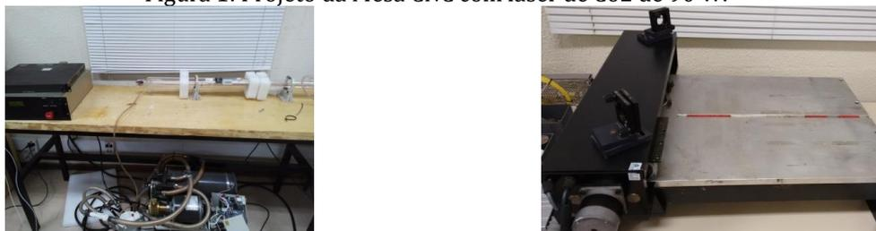
Figura 2: tubo de laser de 90W, fonte de controle e alimentação, *chiller* para refrigeração do laser e mesa de movimentação acoplada a dois motores de passo.
