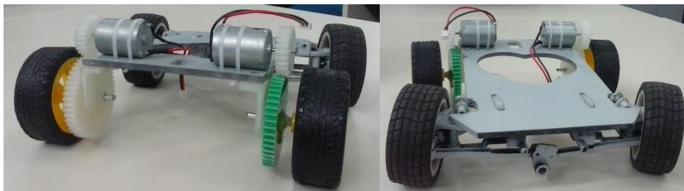
Figura 2. Montagem do veículo com as engrenagens e os mancais
