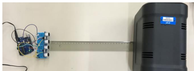
FIGURA 1: Montagem do teste com o protótipo com LED's e os sensores ultrassônicos, sendo o intervalo entre ele e a fonte considerado a distância normal.
