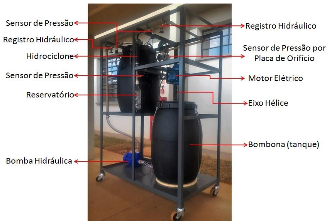
FIGURA 1. Vista geral do protótipo com os itens detalhados na estrutura
