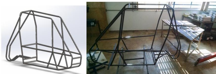
FIGURA 3. Segundo chassi: visualização no software à esquerda e construído à direita.
