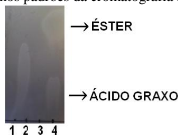
Figura 3. Cromatografia dos produtos obtidos pela esterificação do ácido láurico.
