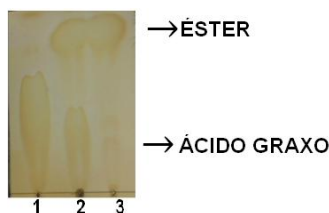
Figura 1. Cromatografia dos produtos obtidos pela esterificação do ácido oleico.
