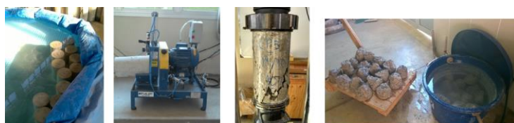
FIGURA 3. Processo de moldagem dos corpos de prova. Etapas 5), 6), 7) e 8), respectivamente. (Fonte: o próprio autor)
