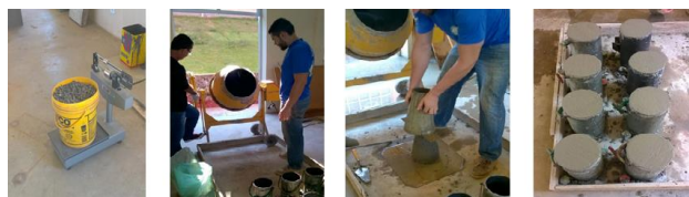
FIGURA 2. Processo de moldagem dos corpos de prova. Etapas 1), 2), 3) e 4), respectivamente. (Fonte: o próprio autor)
