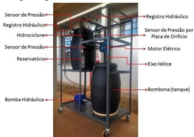
FIGURA 2. Protótipo de separador sólido-líquido por hidrociclone.
