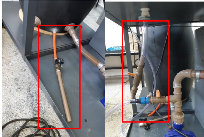
FIGURA 3. Mangueiras adaptadas nos tanques superior e inferior.
