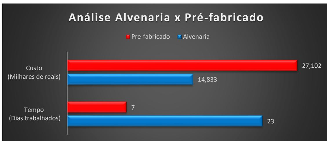
Gráfico 1: Análise de tempo e custo comparando sistema pré-fabricado e alvenaria comum.
