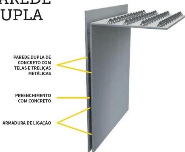
Figura 2: Parede dupla de concreto pré-fabricado, Sudeste (2019)
